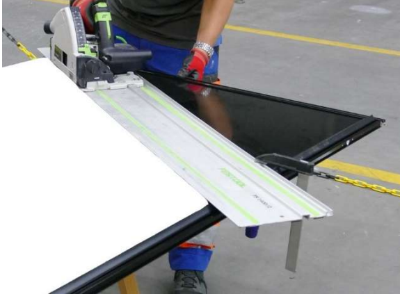
Abb. 8: Zuschnitt Blindmodul mit Handkreissäge
