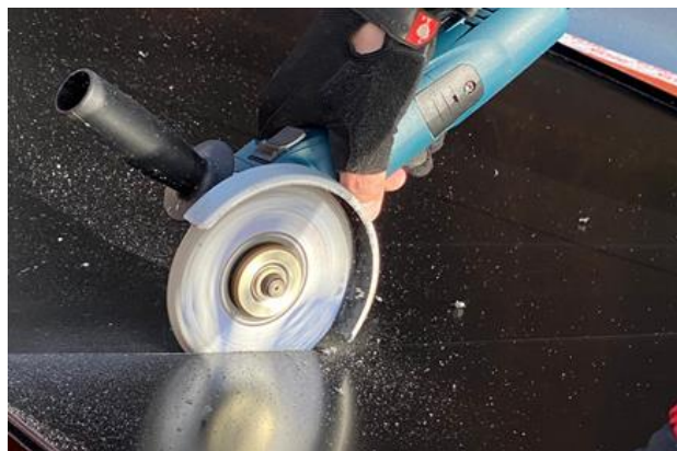
Fig. 11: Découpe avec une scie circulaire Flex
