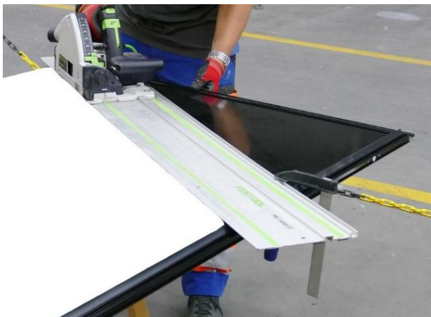
Fig. 8: Découpe du module factice à la scie circulaire manuelle
