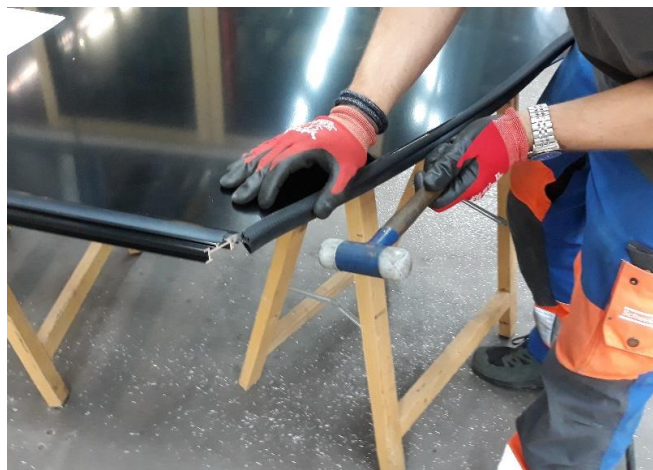
Fig.13: Pose de la bande-acier en tant qu'élément de finition du bord de coupe
