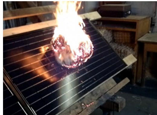
Figure 1: Contrôle de la résistance aux flammèches et à la chaleur rayonnante
