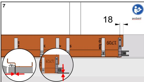
Montagelehre an Traufprofil anschlagen. Profilhübel mit Montagelehre setzen.
