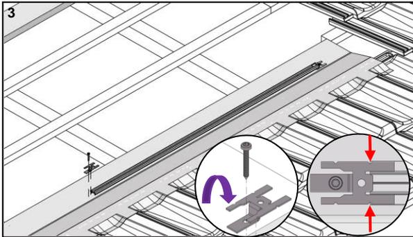
Hafte drehen, ausrichten und satt verschrauben. Positionsmarken beachten, damit ausreichend Spiel für die Längenausdehnung des Traufprofils vorhanden ist.
