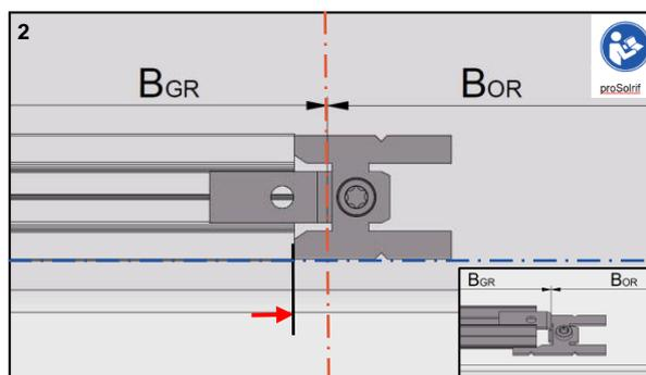
Traufprofil an Referenz (Blau) und Hafte zu B<sub>OR</sub> ausrichten. Hafte mit Schraube befestigen. Schraube satt eindrehen. Traufprofil bis zum Anschlag der Hafte einschieben.
