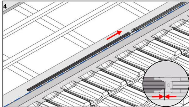
Nächstes Traufprofil unter die Hafte auf Anschlag schieben und an Referenz ausrichten. Schritt wiederholen bis zum Ende des PV-Feldes.
